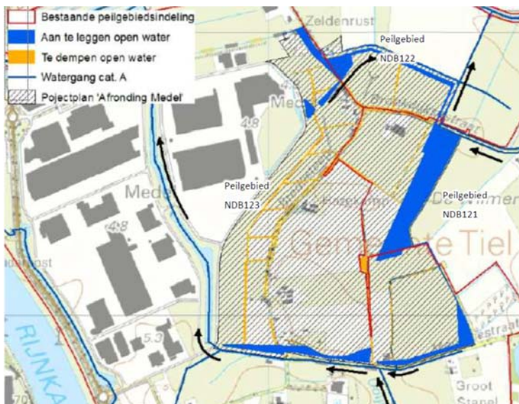
Afbeelding 7.2.: Afwateringsstructuur Bedrijvenpark Medel Afronding (Witteveen&Bos, 2015)
