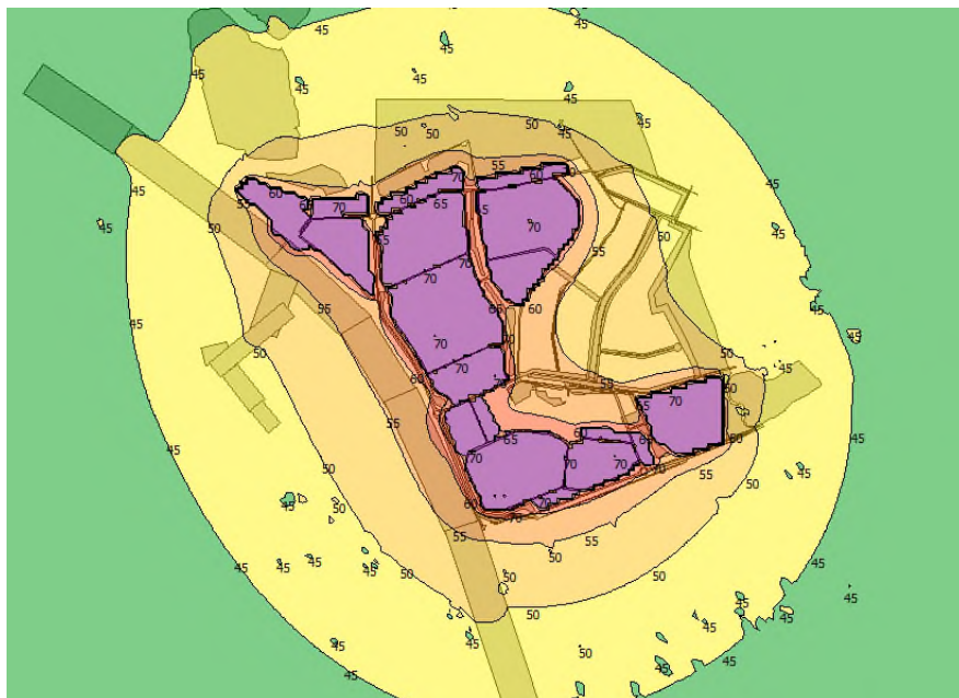
figuur 5.2 Geluidcontouren geluidbelasting L_{etm} [dB(A)] industrielawaai referentiesituatie (de labels in de figuur geven per contour de geluidbelasting aan)
