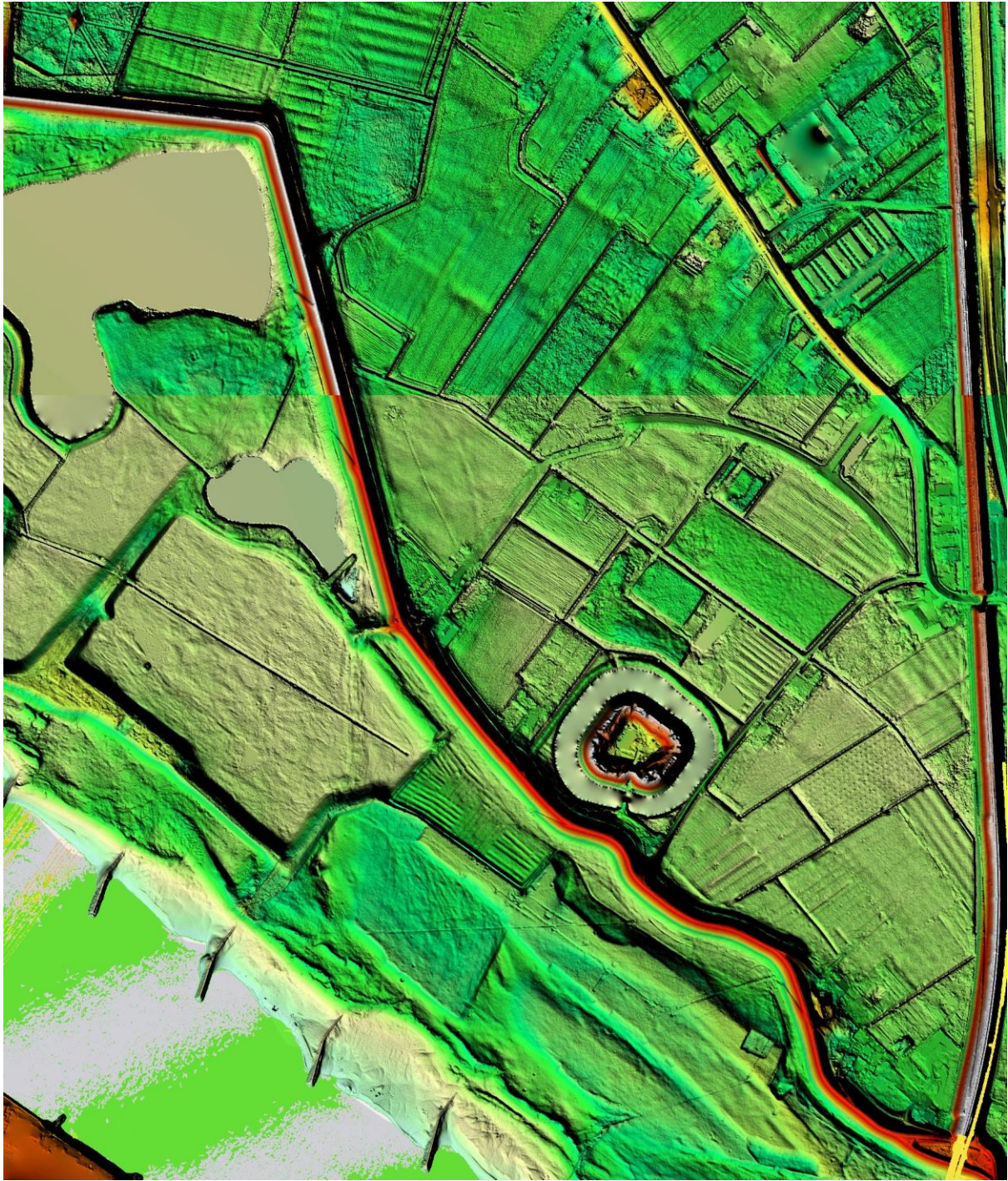
Op de AHN-kaart zijn de hoger gelegen structuren in het gebied duidelijk zichtbaar, zoals de Waalbandijk, de Griftdijk en de kwelkade aan de buitenzijde van de fortgracht (bron: www.ahn.nl )
