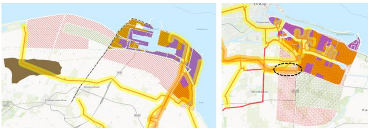
Figuur 13-17 Buisleidingen in het studiegebied t.h.v. Eemshaven en Oosterhorn (rood: 30 meter, geel: 200 meter, oranje: nog uit te geven kavels, paars: bestaande bedrijven)
