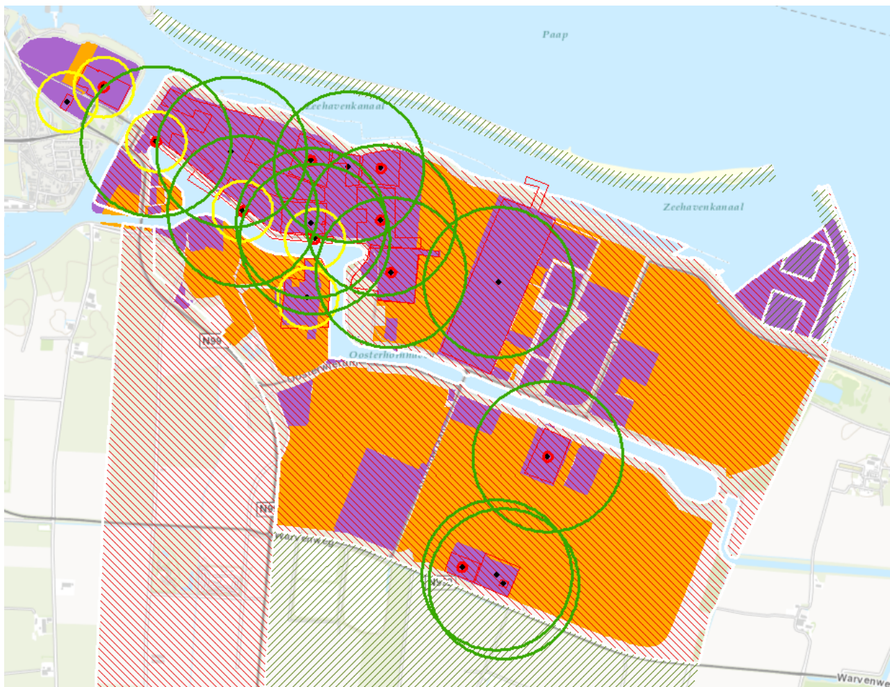
Figuur 13-7 Signaleringsafstanden risicovolle inrichtingen Oosterhorn (oranje: nog uit te geven kavels, paars: bestaande bedrijven, zwart: risicobronnen, rood: brandbaar, geel: explosief, groen: toxisch)
