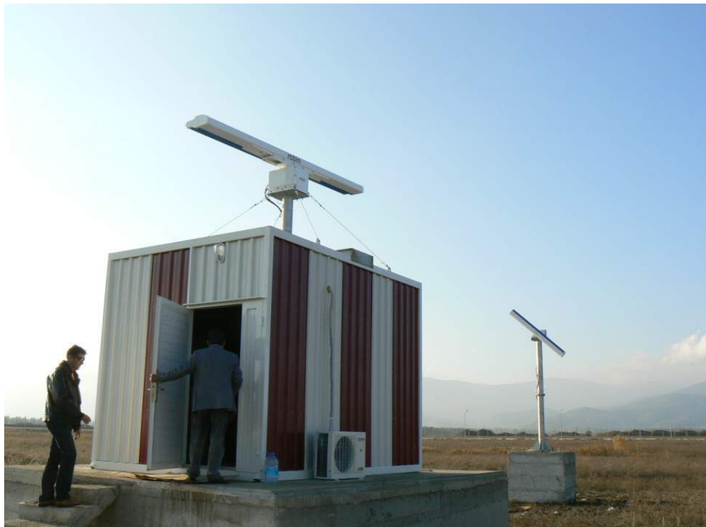
Indruk van een horizontale (links) en een verticale radar, in dit geval van Robin radar. In de container staat de processingapparatuur. Foto Robin Radar.
