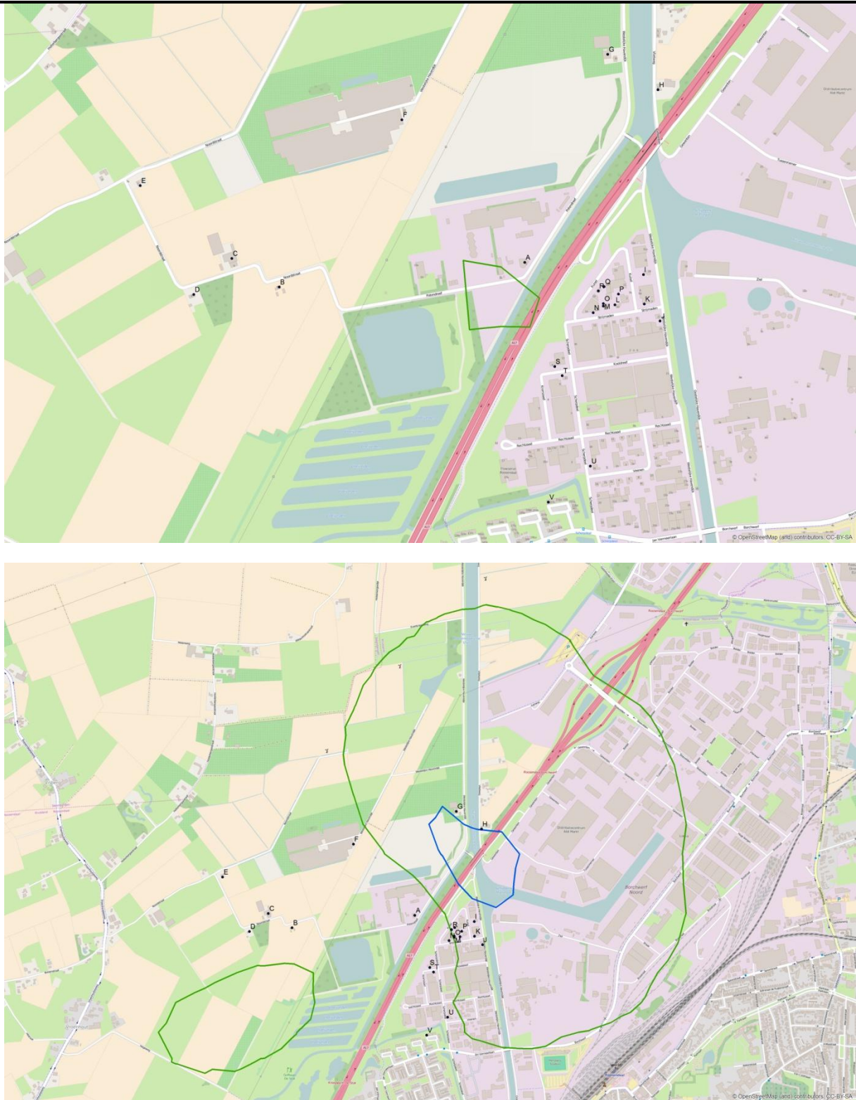
Figuur 5.1 Boven (A) geurcontouren voor scenario A1, onder (B) geurcontouren scenario ZD3. Contouren zijn getekend voor streef- (groen) en richtwaarde (blauw) van respectievelijk 0,5 en 1 \text{ ou}_e/\text{m}^3
