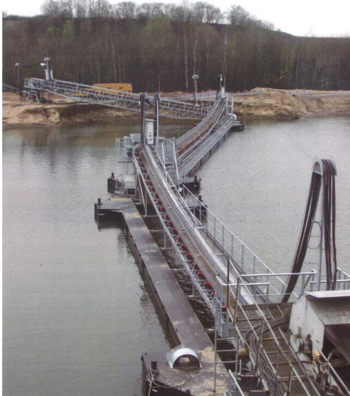
Figuur 5.5 Referentiebeeld variant C2, toepassing van transportbanden.
