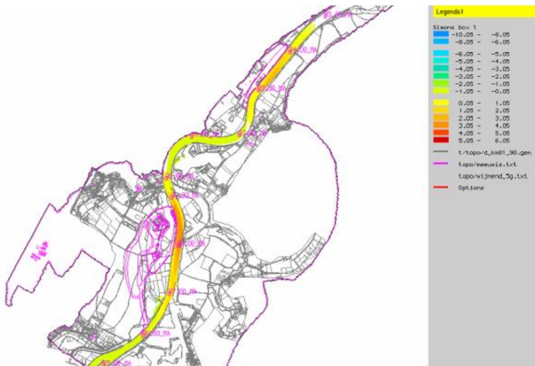
Figuur 6.1 Berekende erosie/sedimentatie door veranderingen in de stroomsnelheid [101]
