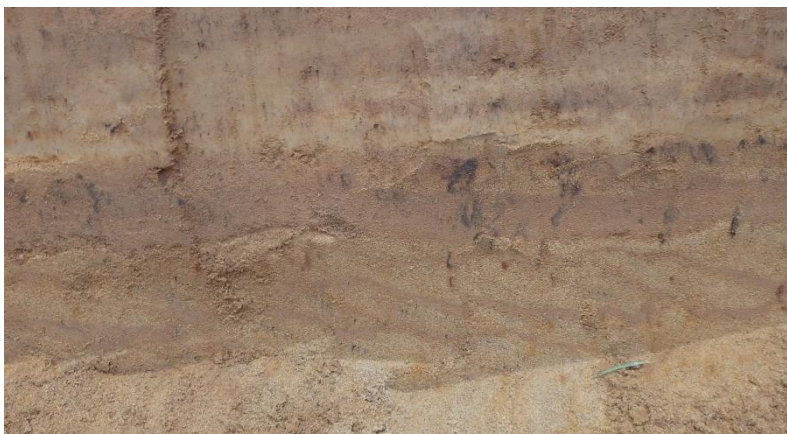
Afb. 14 Profiel put 4. Scheve gelaagdheid in pleistocene beddingafzettingen.
