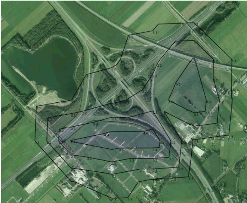
Figuur 7.14 Berekende toename van fijn stof (PM10) als gevolg van bedrijven op bedrijvenpark H2O
