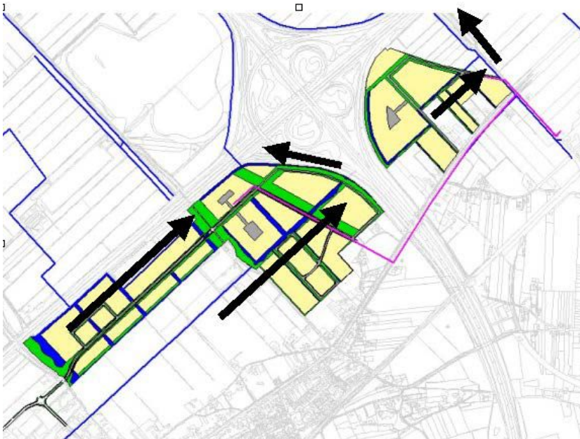
Figuur 8.9 Overzicht berging en afwatering
