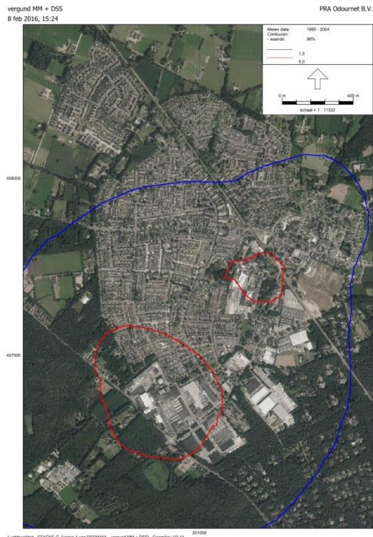
Figuur c: Contouren van 5 en 1,5 ou_E/m^3 als 98-percentielwaarde in de vergunde situatie
