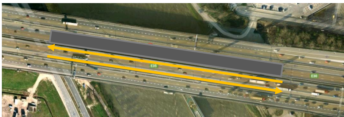
figuur 2 Gemeten rijstroken van het Hoogsterktebeton (HSB) op de Galecopperbrug (A12)
