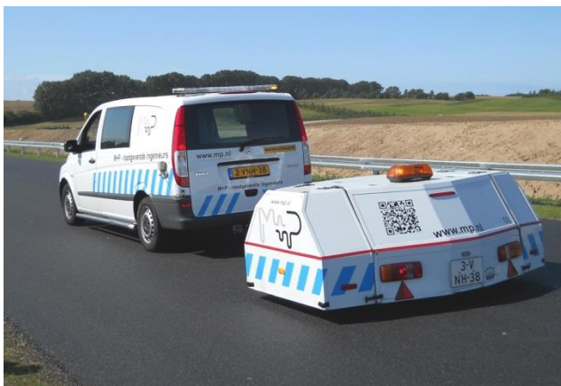
figuur 1 Foto van de M+P CPX-trailer gedurende een meting
