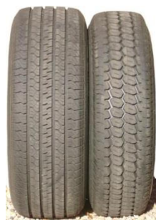
figuur 7 CPX-banden volgens de laatste tekst van ISO/DIS 11819-2: P1 (links) en H1 (rechts)
