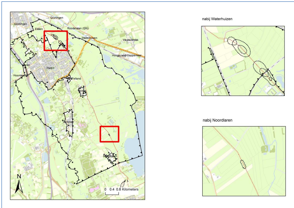
Figuur 10 overzicht plaatsgebondenrisicocontouren gasbuisleidingen
