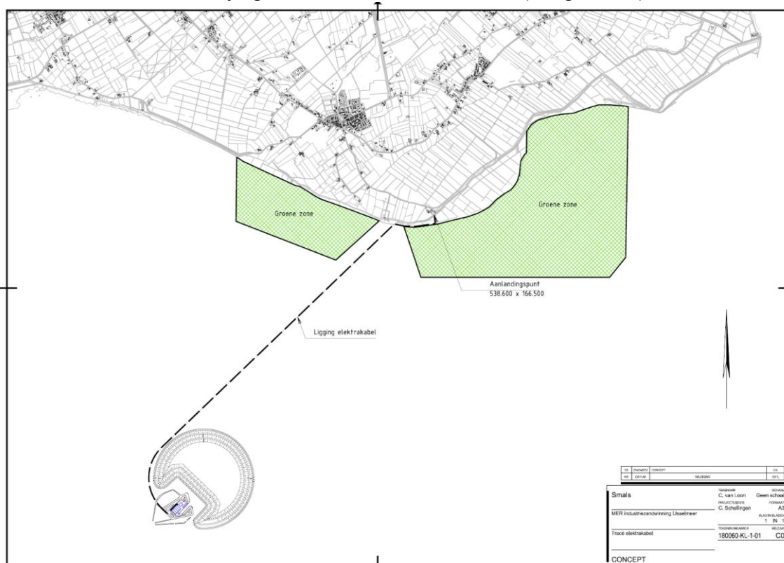
Figuur 8-26: Situering elektriciteitskabel in het IJsselmeer ten opzichte van Beschermd naturomumenten (groene vlakken) langs de kust
