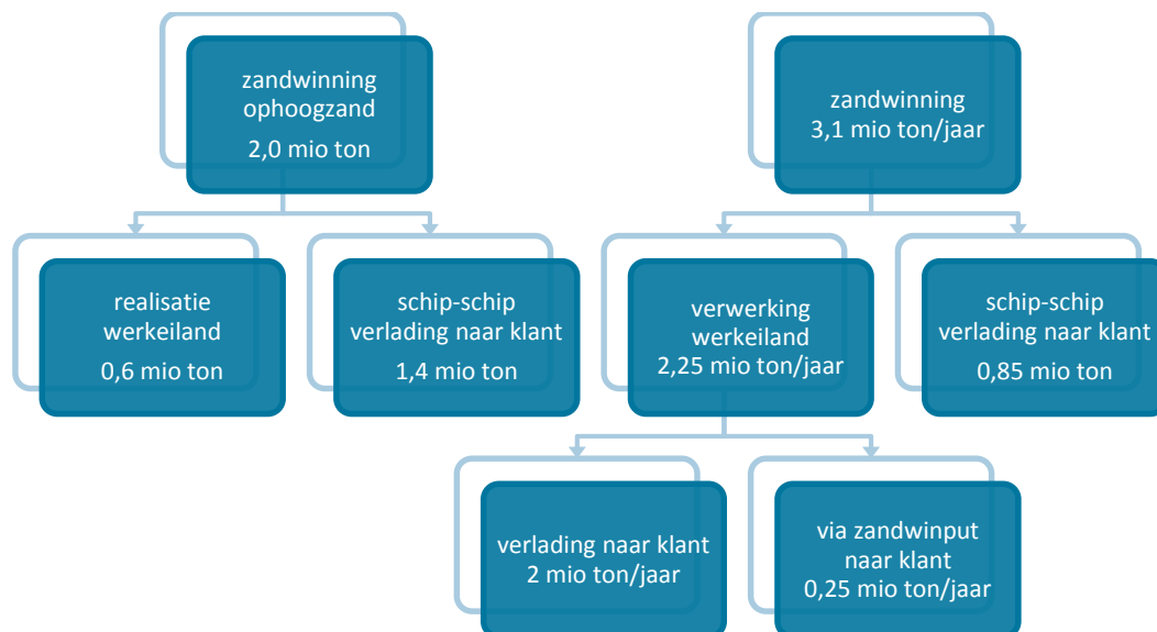
Figuur 2.1: Overzicht grondstromen (links is opstartfase en rechts is werkfase)
