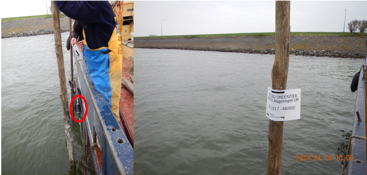
Foto Links: de fuikpalen worden gezet om de receivers te bevestigen (VEMCO receiver is nog zichtbaar). Rechts: alle palen worden voorzien van een duidelijk kenmerk dat ze ingezet zijn voor onderzoek. Foto IMARES (Olvin van Keeken).
