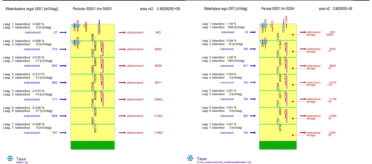
Figuur 4.5 Waterbalansen met winning, stationair (links) en instationair (rechts)
