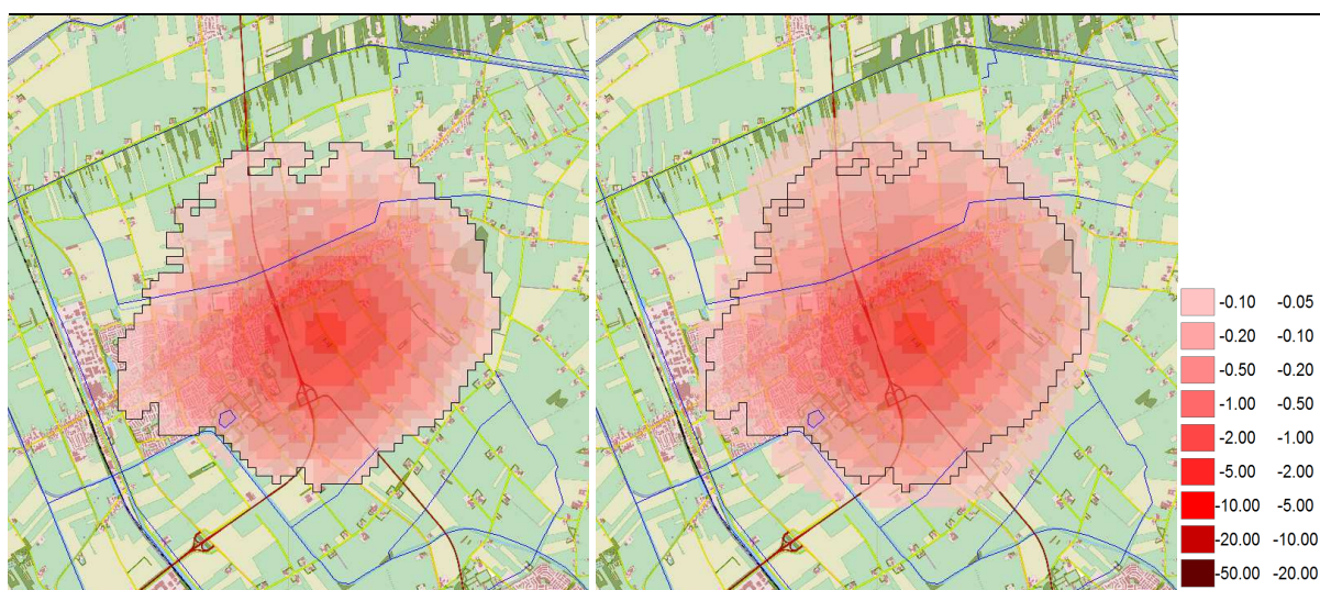
Figuur 2.2 Stationaire verlaging (links) en instationaire gemiddelde verlaging (rechts)
