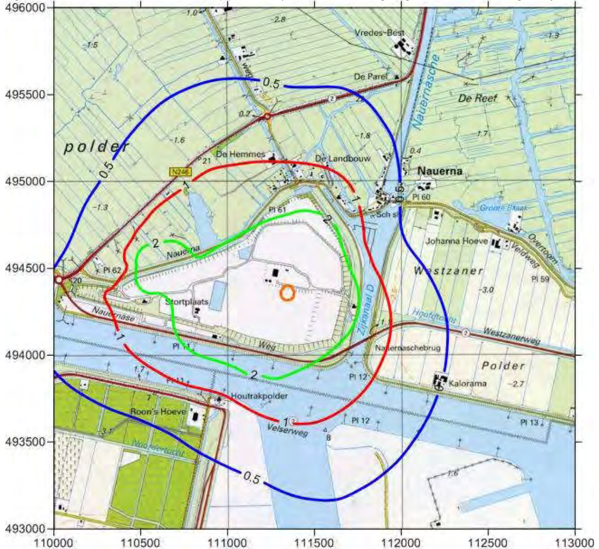
Figuur. Geurcontouren van 0,5, 1, 2 en 10 ou E (H)/m 3 als 98-percentielwaarde als gevolg van het afvalverwerkingsbedrijf.
