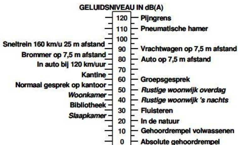
Figuur 48 – Indicatie van geluidsniveau in dB(A) en representatieve vergelijkingen [5]
