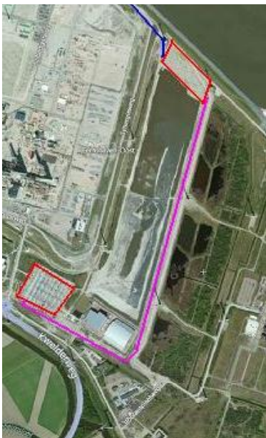
Figuur 30: Route 380 kV kabel tussen convertorstation (boven) en TenneT-station Oudeschip (onder).
