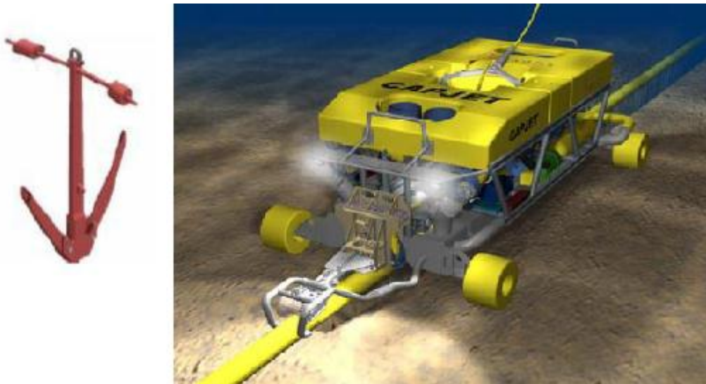
Figuur 15: Een grapnel anker (links) en jetting too (op een Remote Operated Vehicle – ROV) met een kabel (rechts).
