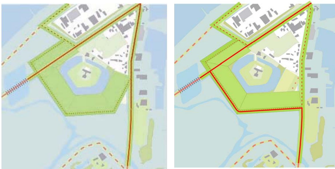
Figuur 5.8 Varianten voor dijkligging (aansluiting op de Merwededijk) rond het Fort en de ontsluiting (rode lijn) van Steurgat
